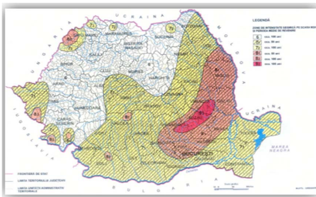
Zonarea seismică a teritoriului României.
