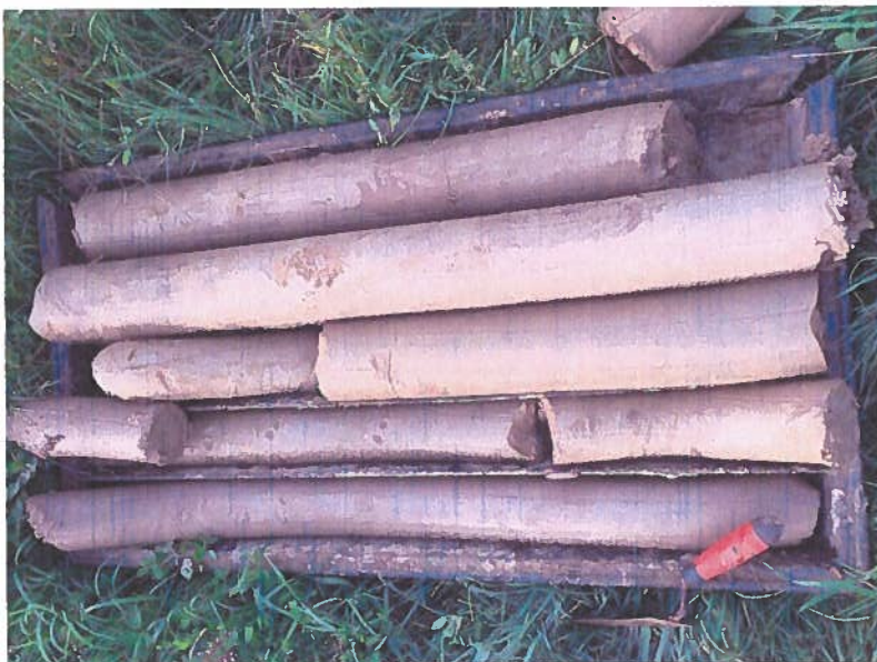
Figura 10.b: Stratificația întâlnită în forajul F1
