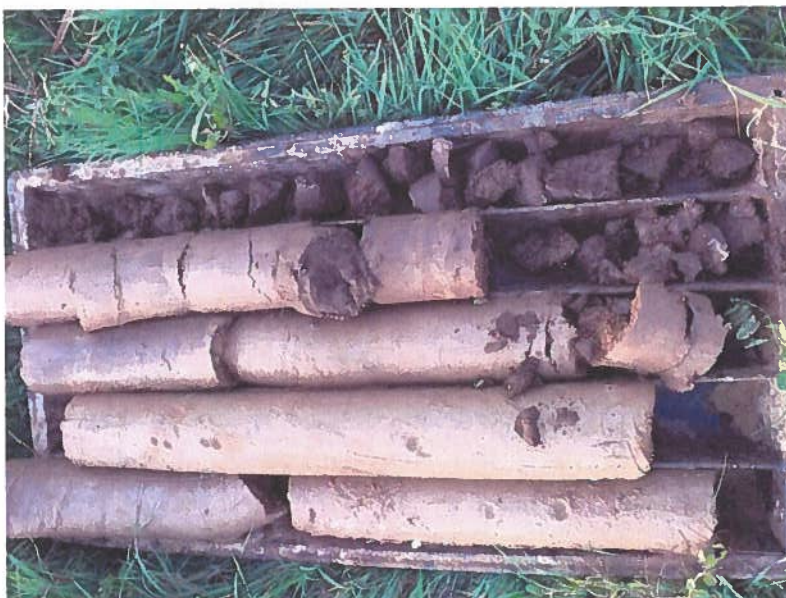
Figura 10.a: Stratificația întâlnită în forajul F1
