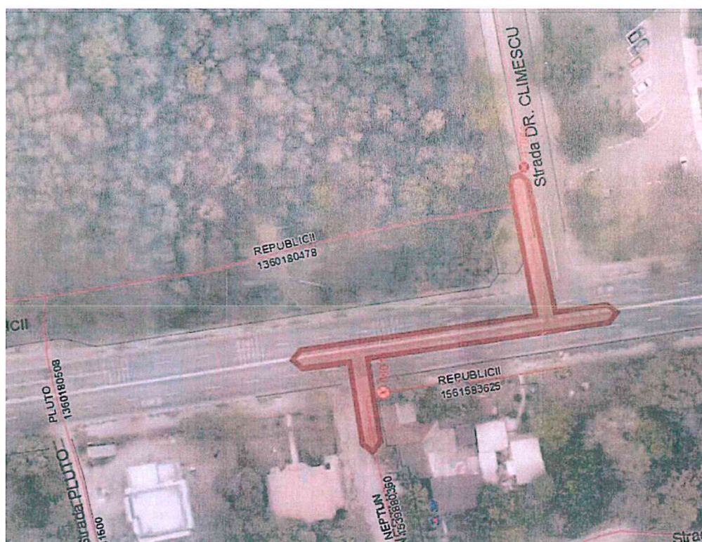
Fig.3 – Pozitionarea retelor de gaz
